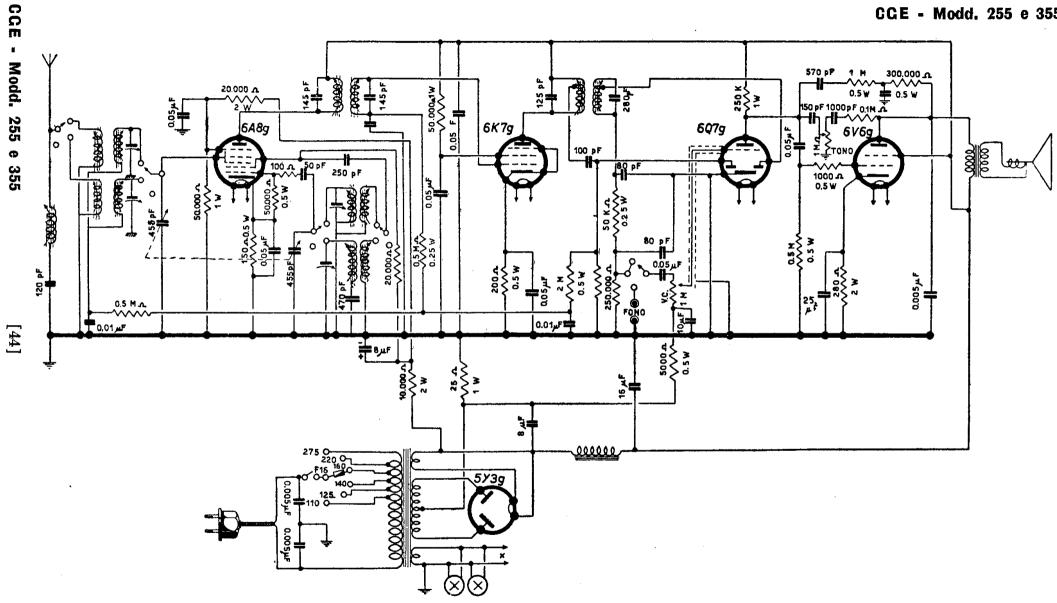
COMPAGNIA GENERALE DI ELETTRICITA' - Modelli 255 e 355 - Gamme di ricezione: da 190 a 580 m e da 17 a 50 m. Blocco alimentazione su telaio a parte. Potenza: 4,2 W. MF: 468 kc/s. Il mod. 355 differisce dallo schema per avere in più una EM4, indicatrice di sintonia (v. tabella a parte).
